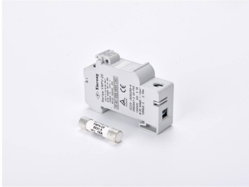
熔体额定电流不等于熔断器额定电流，熔体额定电流按被保护设备的负荷电流选择，熔断器额定电流应大于熔体额定电流，与主电器配合确定。熔断器主要由熔体、外壳和支座3部分组成，其中熔体是控制熔断特性的关键元件。熔体的材料、尺寸和形状决定了熔断特性。熔体材料分为低熔点和高熔点两类。低熔点材料如铅和铅合金，其熔点低容易熔断，由于其电阻率较大，故制成熔体的截面尺寸较大，熔断时产生的金属蒸气较多，只适用于低分断能力的熔断器。高熔点材料如铜、银，其熔点高，不容易熔断，但由于其电阻率较低，可制成比低熔点熔体较小的截面尺寸，熔断时产生的金属蒸气少，适用于高分断能力的熔断器。熔体的形状分为丝状和带状两种。改变截面的形状可明显改变熔断器的熔断特性。熔断器有各种不同的熔断特性曲线，可以适用于不同类型保护对象的需要。
